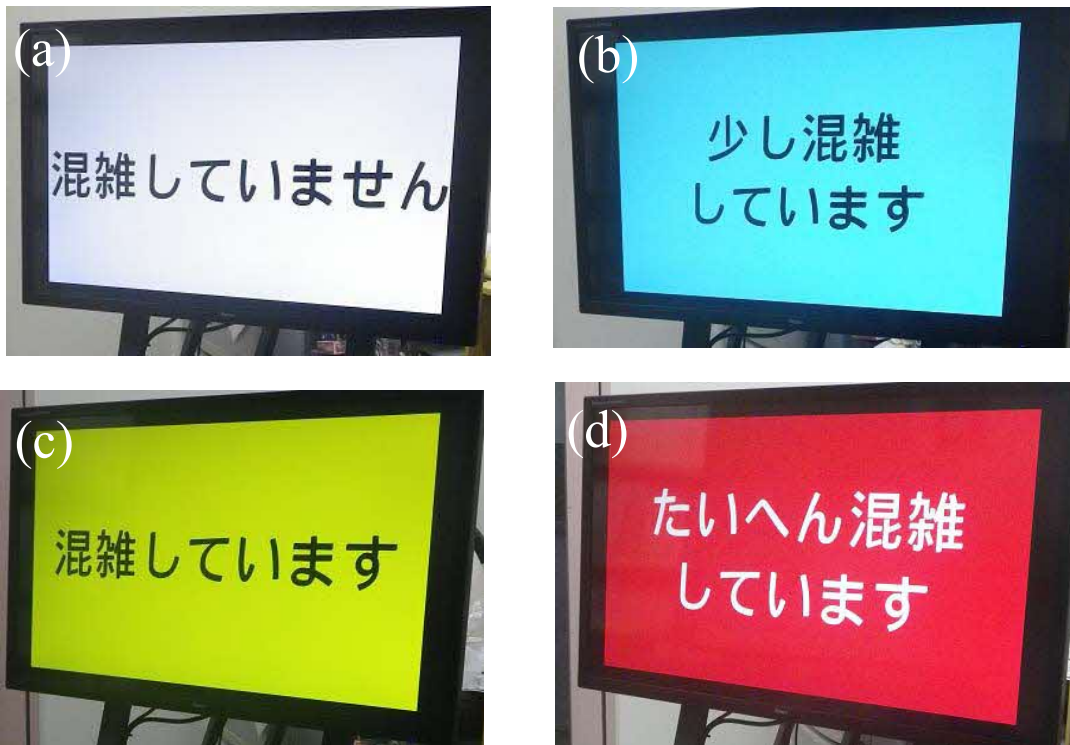
図5 サイネージへの表示 (a) 混雑していない場合（認識したオブジェクト数が0個）、(b) 少し混雑している場合（認識したオブジェクト数が1個）、(c) 混雑している場合（認識したオブジェクト数が2個）、(d) 非常に混雑している場合（認識したオブジェクト数が3個以上）
